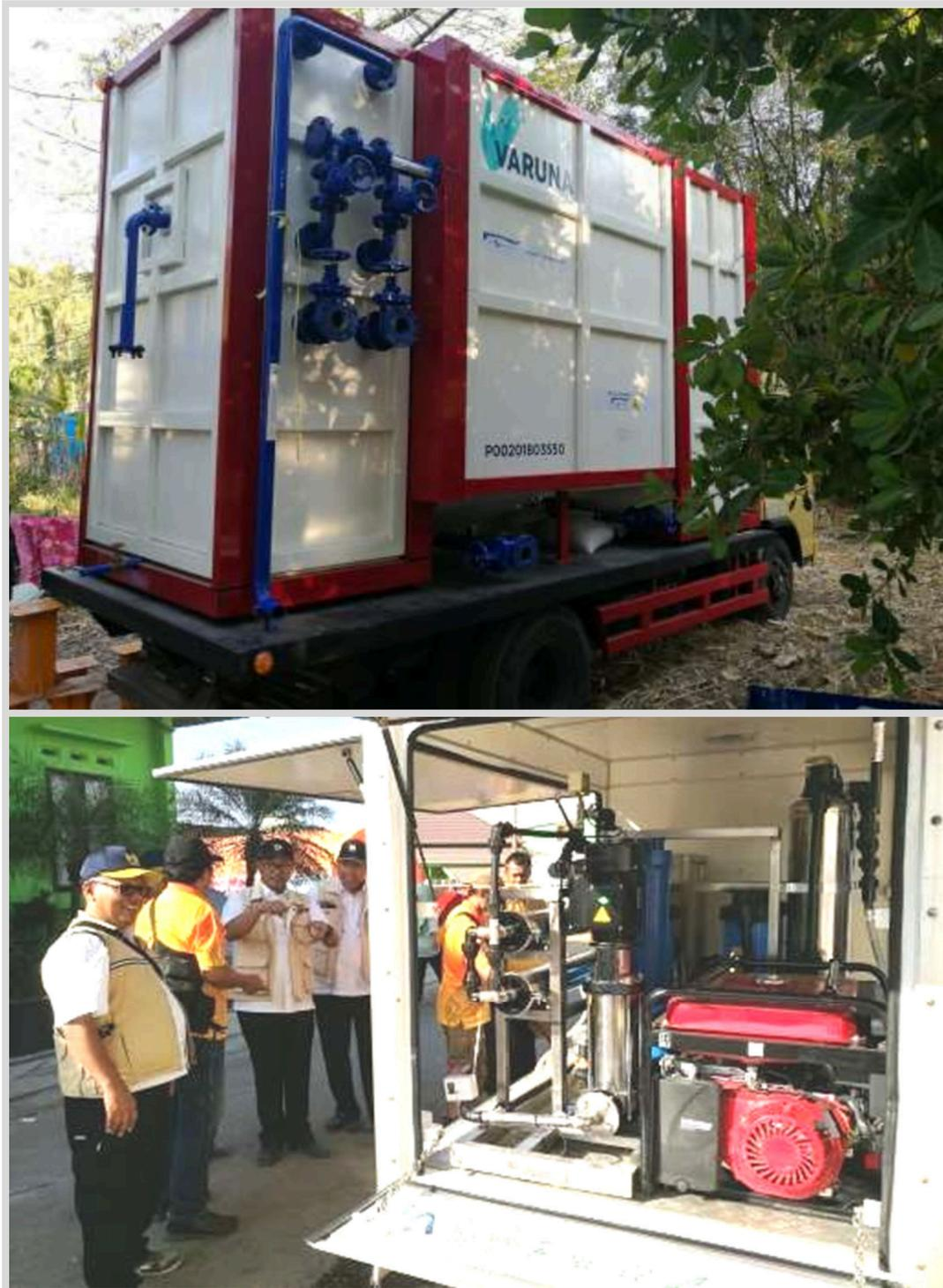
Gambar 39. IPAL Mobile bantuan dari LPPM ITB untuk membantu pemenuhan kebutuhan air bersih (Sumber: Satgas PB PUPR Lombok, 2018)
